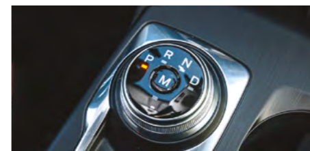
Tavapärast automaatkäigukasti valitsat asendab pöördnupp keskkonsoolil.
